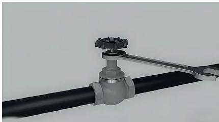
Im Falle einer Undichtigkeit am Schaft ziehen Sie die Mutter der Stopfbuchse mit einem Schraubenschlüssel vorsichtig fest. Wenn die Undichtigkeit weiterhin besteht, muss die Stopfbuchspackung ausgetauscht werden.
